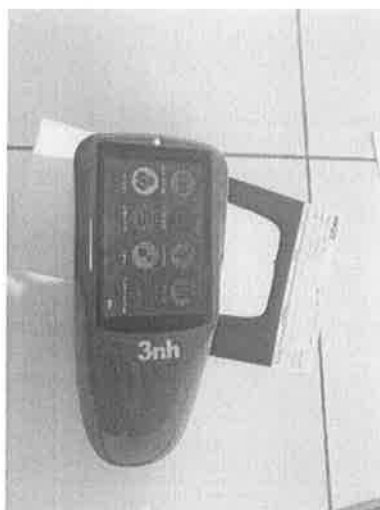
Kolorimetr pro přesné určení barvy a odstínu silikátové nátěrové hmoty
