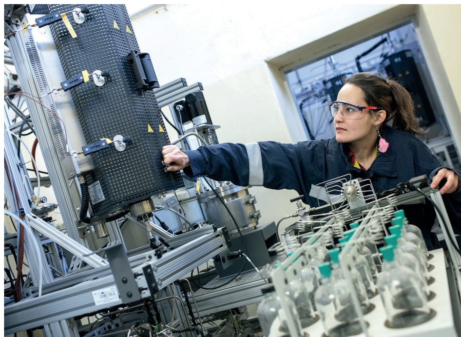
Obr. 1: Uzavírání izolace reaktoru na nové pokusné jednotce (Foto: UniCRE)
